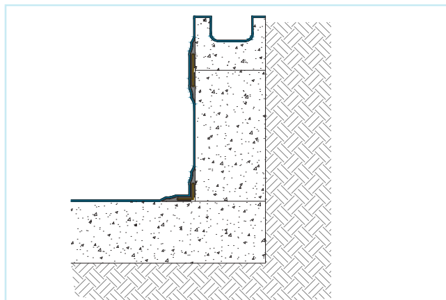
1.2 Impermeabilizzazione di canale preformato
